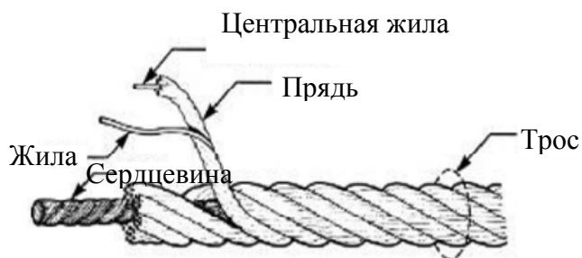
Три основных компонента стального троса
