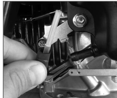
Рис. 16 Топливный фильтр
